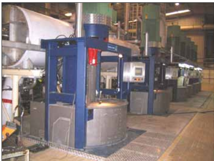
Рис. 2. Центрифуги из зеркальной нержавеющей стали
