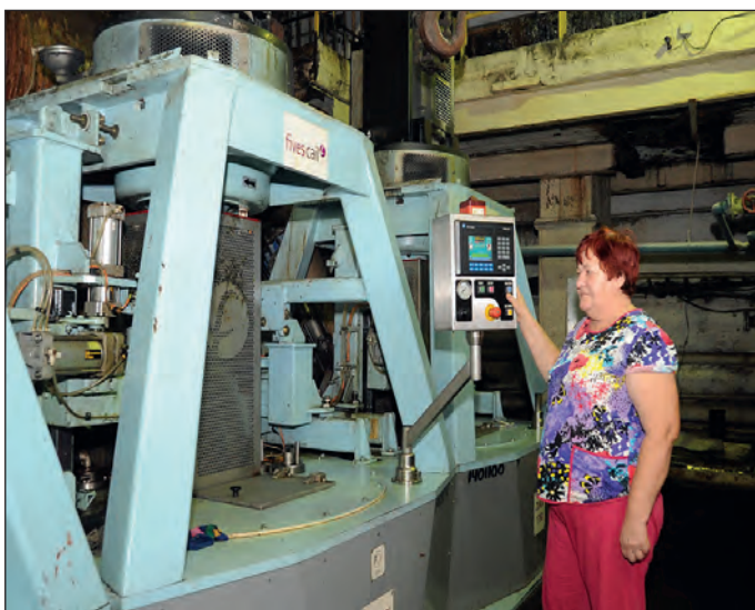
Центрифуга первого продукта ZUKO-1750. Центрифуговщиц Н.В. Кудрявцева
