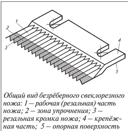
Общий вид безрёберного свеклорезного ножа: 1 – рабочая (резальная) часть ножа; 2 – зона упрочнения; 3 – резальная кромка ножа; 4 – крепёжная часть; 5 – опорная поверхность
