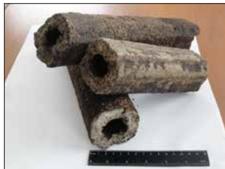
Рис. 2. Топливный брикет PINI&KAY из свекловичного жома плотностью 1,3 г/см 3
