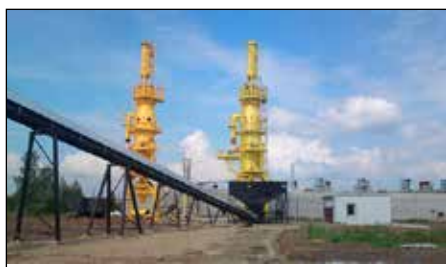
Рис. 1. Промышленная установка по производству биоугля и активированного угля из свекловичного жома
