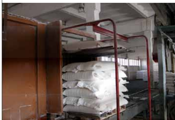
Рис. 2. Пакетоформирующая машина типа У1-УМП
