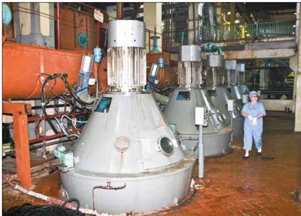
*Станция центрифугирования утфеля второго продукта.
