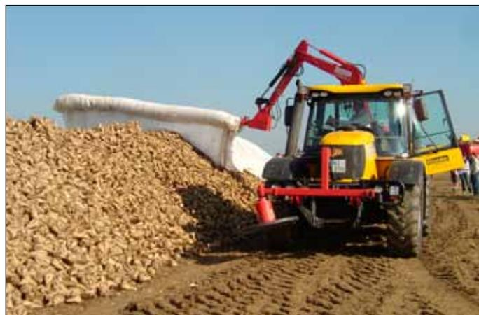
Лучшую технику для укрытия кагатов предлагает фирма Klunder. Машина может укрывать, фиксировать и снимать с кагата полотно шириной от 9,8 до 12 м. Полотном шириной 14,5 м машина Klunder может укрывать кагаты и фиксировать материал, но пока не может его снимать. Для укрытия с помощью машины следует использовать материал площадью до 500 м<sup>2</sup>.
