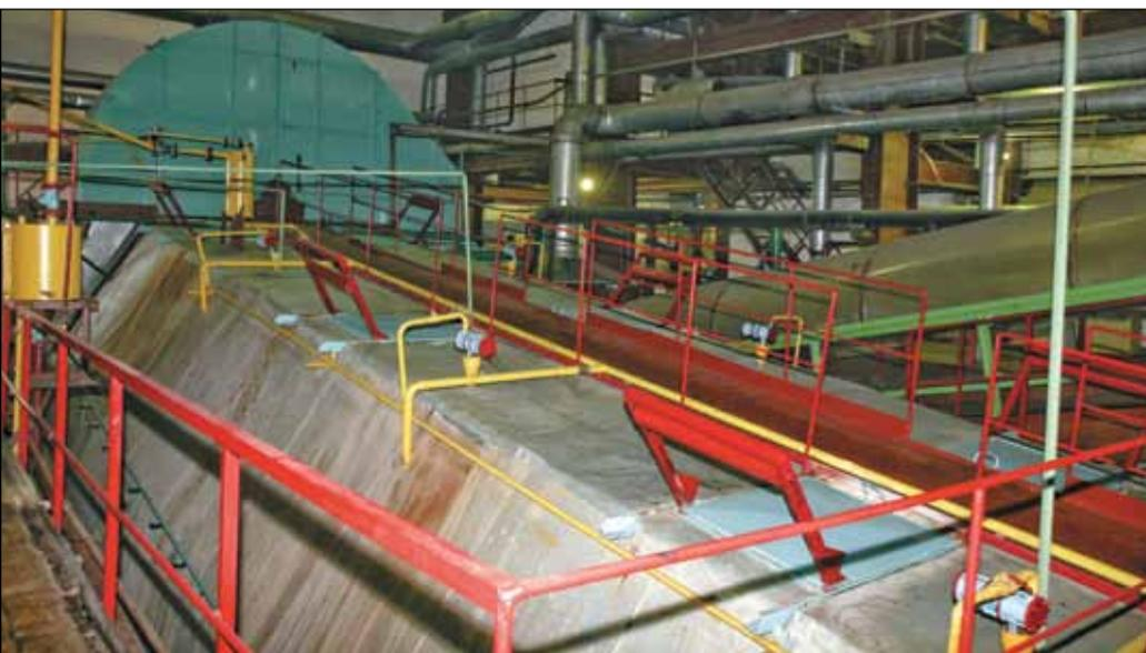
*Диффузионный аппарат DDS-3000*
