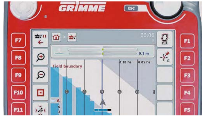
Рис. 4. Пульт управления CCI100, адаптированный к системе ISOBUS
