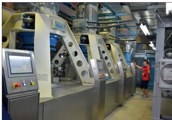
Рис. 4. Центрифуги для утфеля I ступени кристаллизации системы БМА типа E1810
