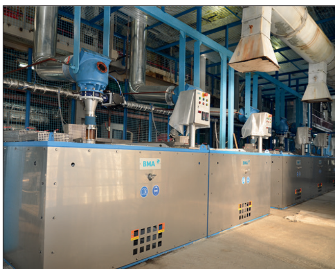
Рис. 5. Центрифуги для утфеля II и III ступеней кристаллизации системы БМА типа K3300
