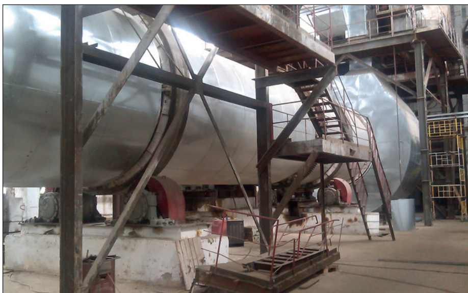
Рис. 2. Модернизированная сушка жомы
