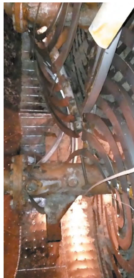
Рис. 2. Фотографии разрушенных витков транспортной системы диффузионного аппарата DC-12
