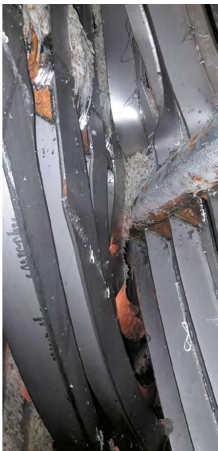
Рис. 2. Фотографии разрушенных витков транспортной системы диффузионного аппарата DC-12
