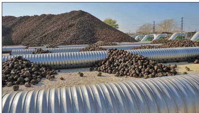
Рис. 3. Укладка кагата сахарной свеклы с системой активной вентиляции и глубокой заморозки
