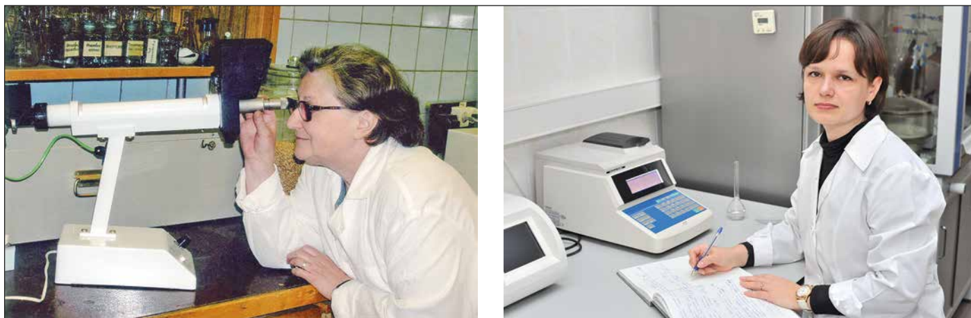
В лаборатории технологии длительного хранения продовольственных товаров и хлебобулочных изделий: определение в сахаре содержания сахарозы и сухих веществ
