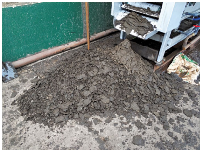
Рис. 5. Выгрузка обезвоженного осадка ТМВ из ленточного фильтр-пресса
