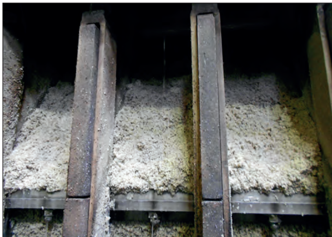
Рис. 1. Пульпа, накопившаяся на перфорированных листах жомового пресса
