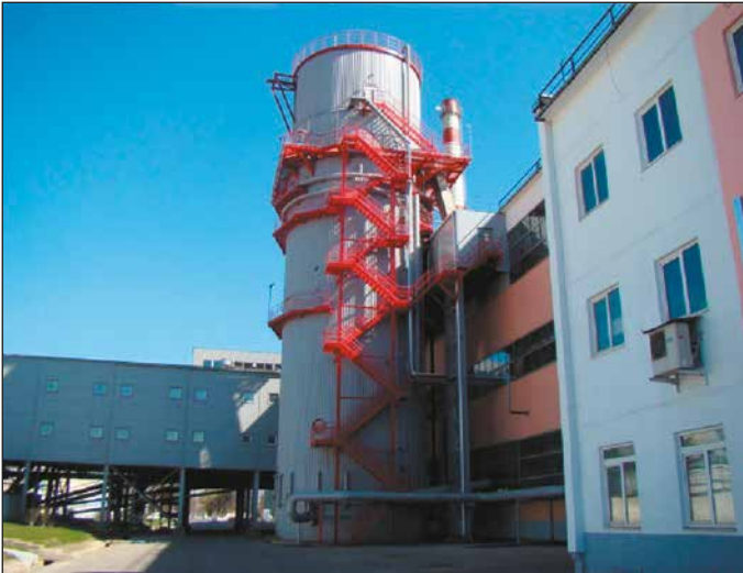
Диффузионный аппарат производительностью 10 тыс. т переработки сахарной свеклы в сутки
