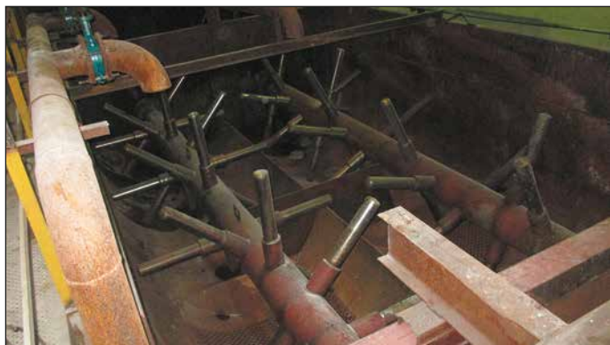
Рис. 2. Свекломойка-оттиратель кулачного типа на базе ШП-ПМД-6
