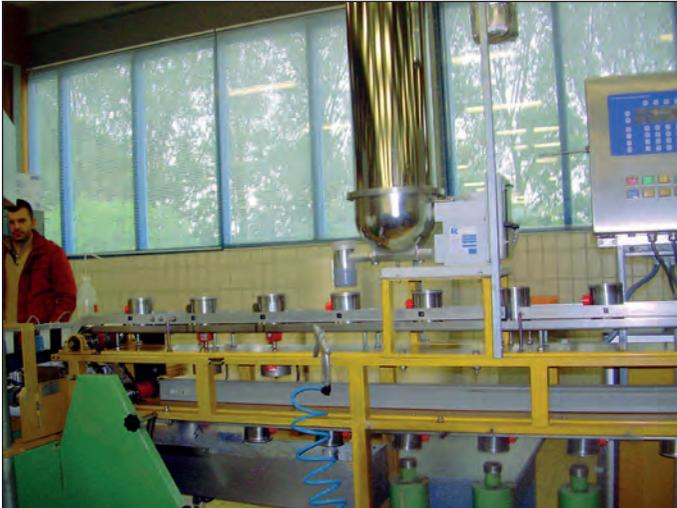
Рис. 11. Линия дигерирования свекловичной кашки с осветлителем
