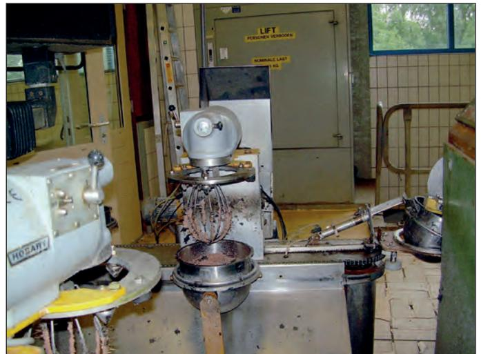
Рис. 10. Гомогенизатор кашки для усреднения пробы перед взятием навески
