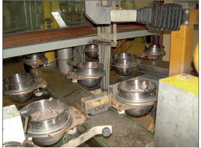
Рис. 9. Приемные сосуды для свекловичной кашки после многопильного станка
