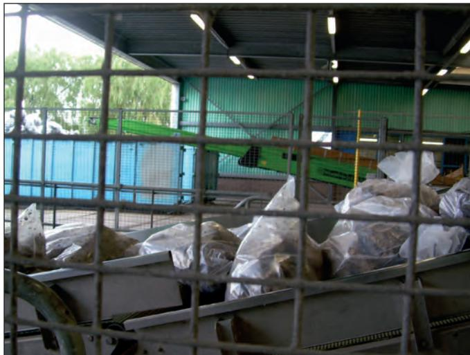
Рис. 8. Подача проб свеклы на анализ в сырьевую лабораторию
