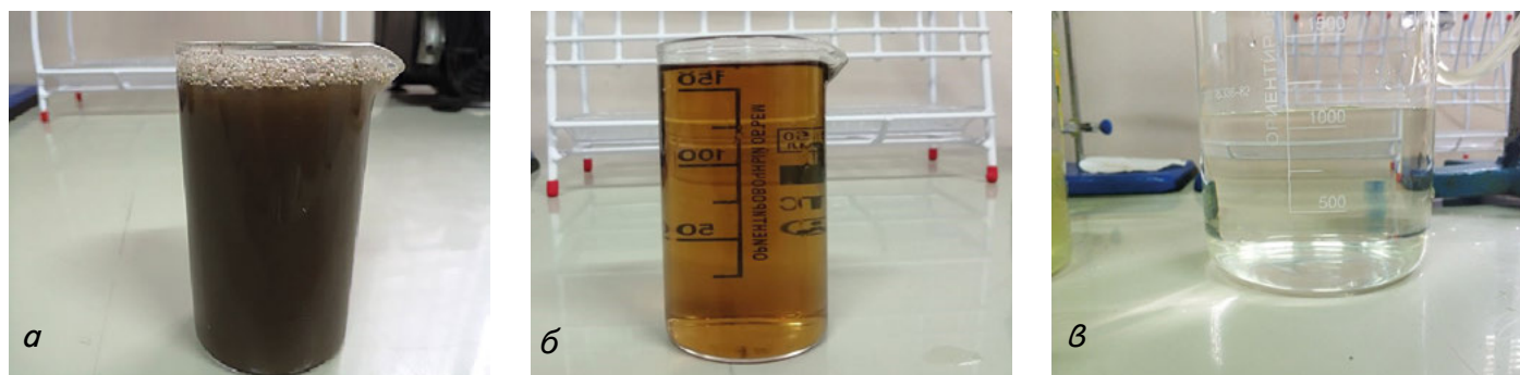
Рис. 3. Изменение качества диффузионного сока на различных этапах очистки: а) диффузионный сок; б) сок после микрофильтрации; в) сок, очищенный перед сгущением
