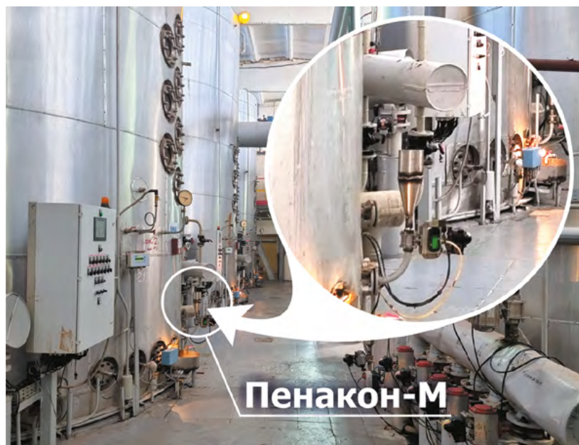
Рис. 3. Место введения препарата «Пенакон-М»
