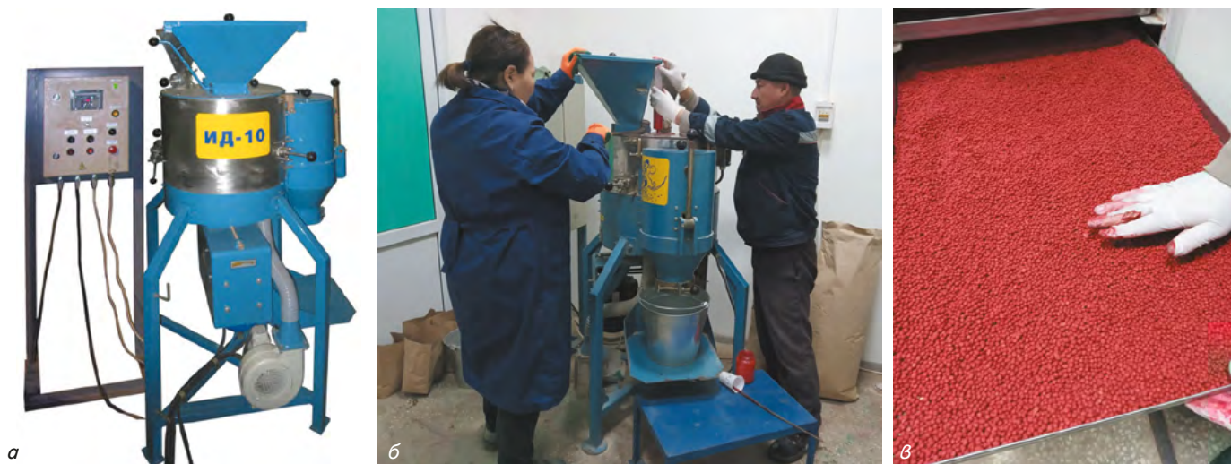
Рис. 1. Процесс дражирования семян сахарной свёклы на аппарате ИД-10: а – ШСС-0,5 (шасталка-тёрка); б – процесс дражирования семян; в – дражированные семена
