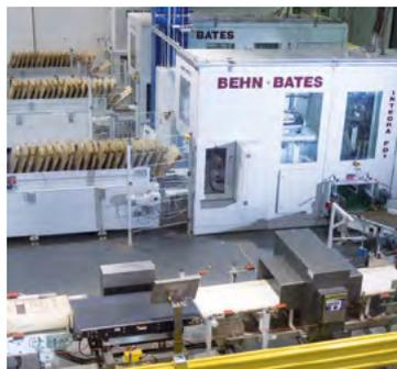
BEHN + BATES INTEGRA® FD: с автоматической насадкой мешка, наполнением и запайкой в закрытом модуле
