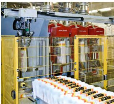
Автоматические наполнительные установки BEHN + BATES для клапанных мешков
