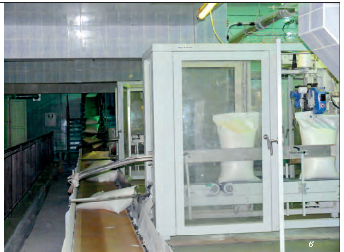
Упаковка сахара в мешки: а – вчера; б, в – в наше время: с применением ручного труда и автоматизированная
