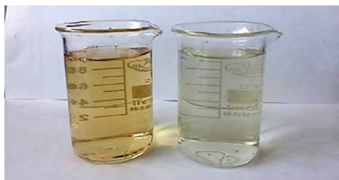
Рис. 4. Очищенный сок (а) и сок после адсорбционной очистки (б), полученные по упрощённой технологии
