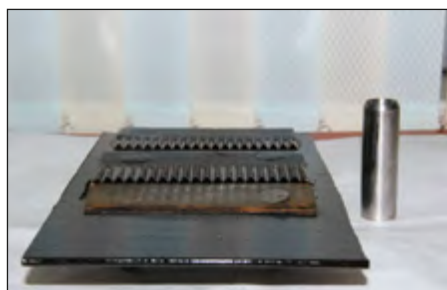
Рис. 1. Полупромышленная установка для получения свекловичной стружки
