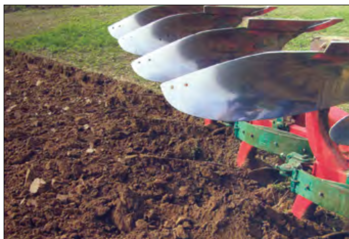
Выровненная поверхность поля по вспашке, выполненная поворачивающимся плугом, позволяет весной ограничить возделывание одним проездом
