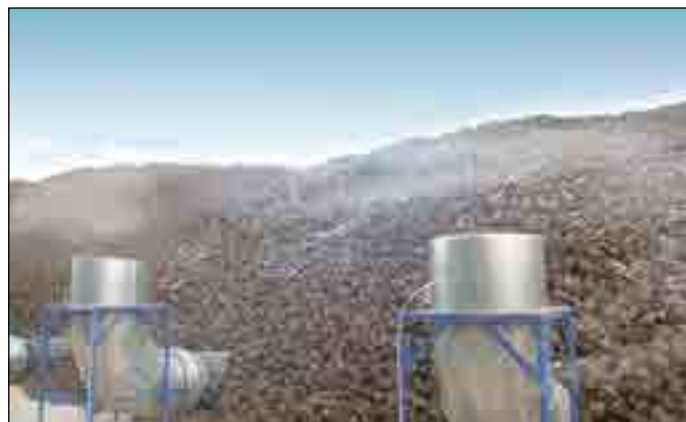
Рис. 2. Дымка «холодного тумана» над поверхностью кагата через 20 минут после прекращения подачи препаратов через систему активного вентилирования
