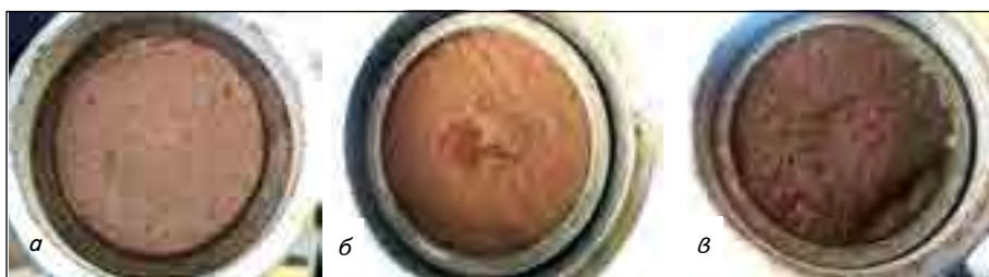
Рис. 6. Осадок после фильтрации сиропа: а – после выпарки (контроль); б – с добавлением флокулянта 0,05% к массе СВ; в – с добавлением флокулянта 0,1% к массе СВ
