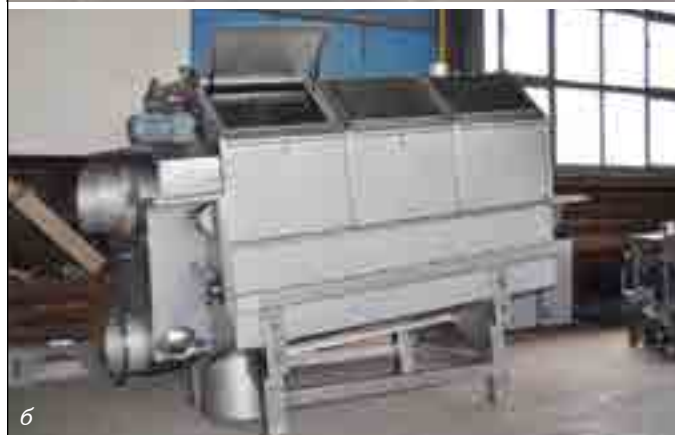
Фильтры для очистки пищевой жидкости (пульполовушки) из нержавеющей стали: а – LB90-300; б – LBW-1230
