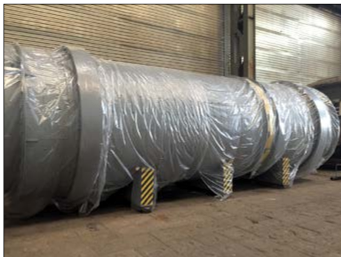
Рис. 1. Сушильно-охладительный барабан — 700 т в сутки
