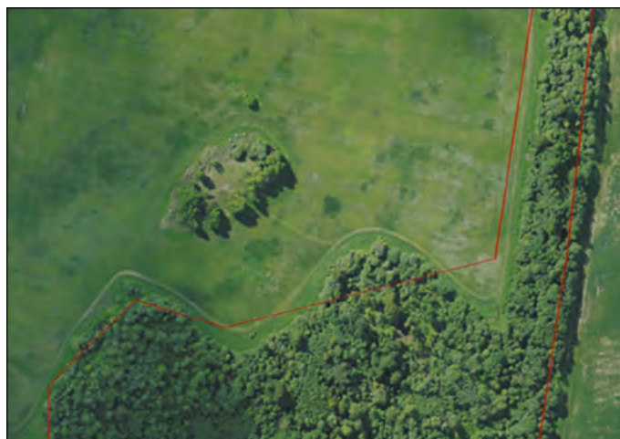
Рис. 5. Контурные земельных участков (по данным публичной кадастровой карты) наложены на ортофотоплан, полученный в результате аэрофотосъёмки
