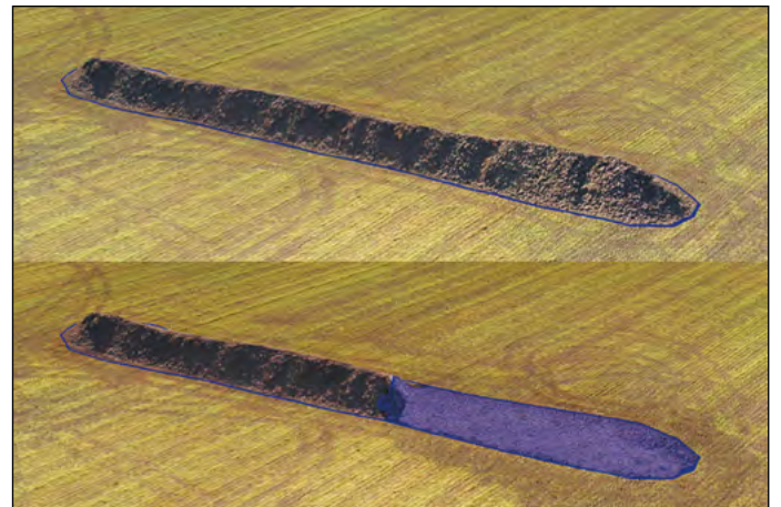
Рис. 4. Измерение разницы объёма кагата по трёхмерной модели
