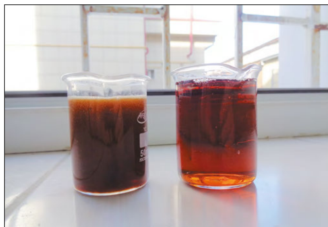
Рис. 1. Фотографии внешнего вида исходного сиропа и фильтрата, полученного фильтрованием через мембрану с размером пор 0,45 мкм
