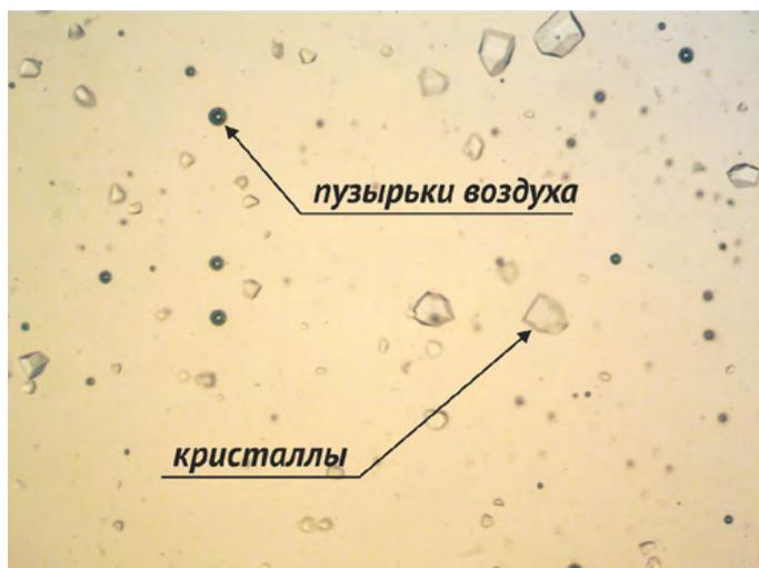
Рис. 4. Микроскопия утфеля (с препаратом «Пенакон-М»)
