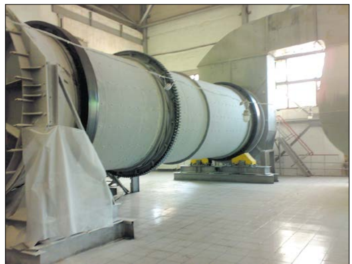
Модернизированный сушильный барабан для сахара
