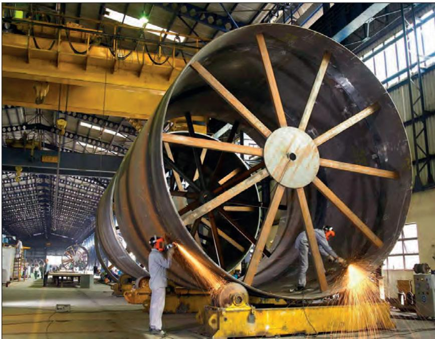
Изготовление сушильного барабана
