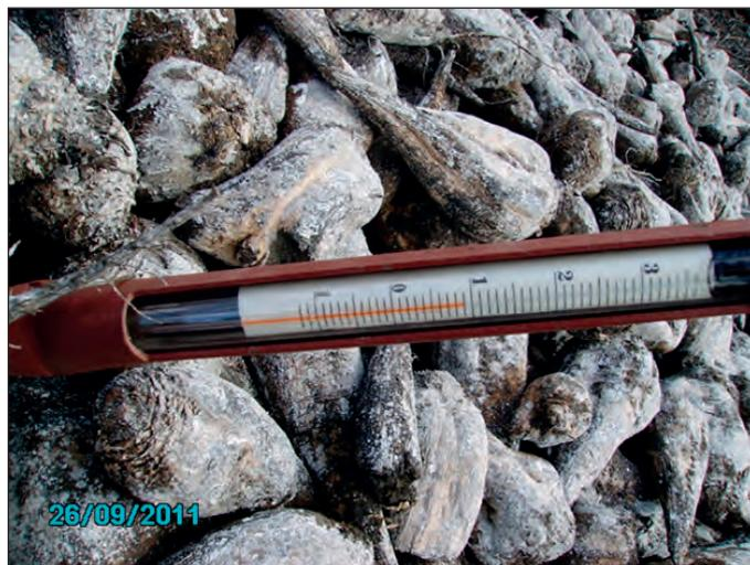
Рис. 6. Измерение температуры внутри кагата
