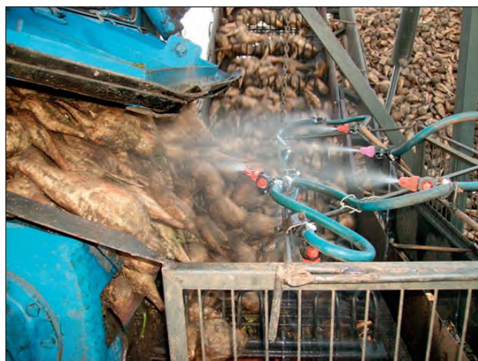
Рис. 5. Приспособление для нанесения препарата «Кагатник» на корнеплоды значительно улучшило равномерность их обработки (установка разработана в филиале «Вейделевка» ООО «Русагро Инвест» в 2011 г.)
