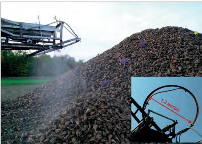
Рис. 2. Установка для обработки корнеплодов сахарной свеклы препаратом «Кагатник» при укладке свеклы в кагат с помощью БУМа
