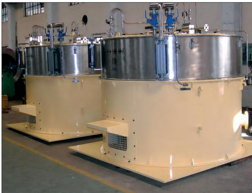
Центрифуги непрерывного действия KC 1500N со встроенной клеровкой
