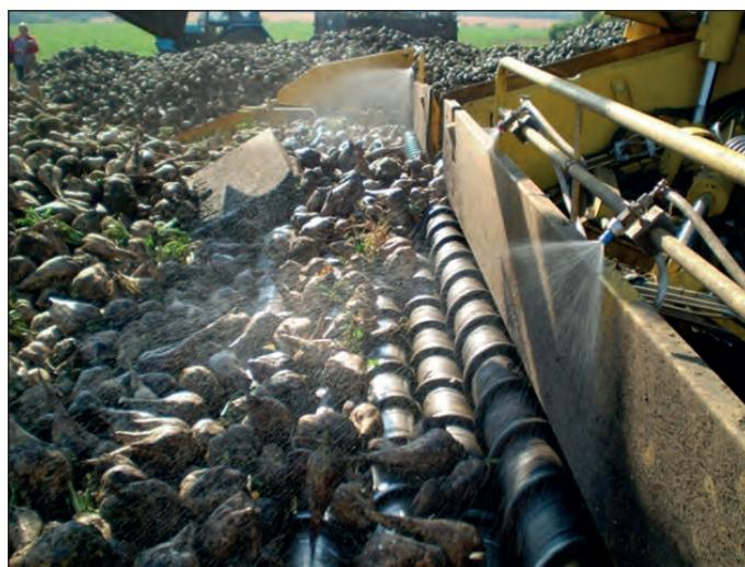
**Рис. 3.** Установка для обработки корнеплодов сахарной свеклы препаратом «Кагатник» с помощью погрузчика Ropa euro Maus-3
