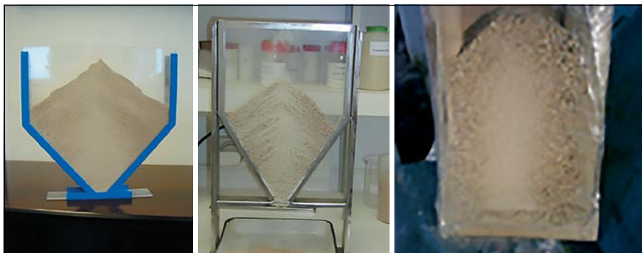
Расслоение премикса и комбикорма при моделировании засыпания его в бункер
