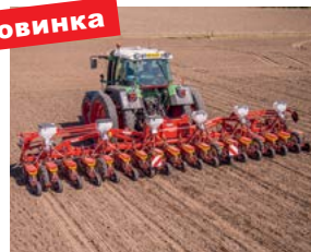
MATRIX 1200/1800: механическая сеялка пунктирного высева
