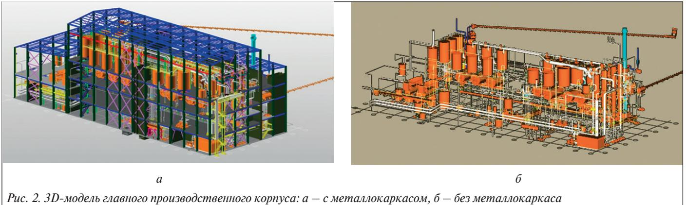
Рис. 2. 3D-модель главного производственного корпуса: а – с металлокаркасом, б – без металлокаркаса
