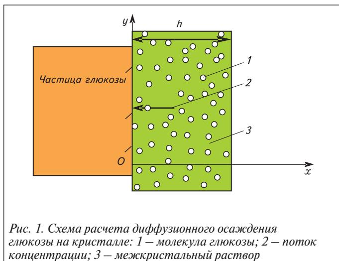
Рис. 1. Схема расчета диффузионного осаждения глюкозы на кристалле: 1 – молекула глюкозы; 2 – поток концентрации; 3 – межкристалльный раствор
