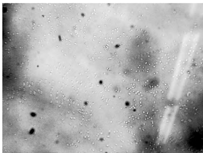
Рис. 4. Исходная жидкостная дисперсионная структура мелассы
