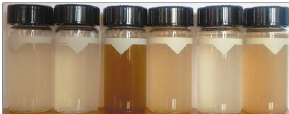
Рис. 2. Кюветы с надосадочной жидкостью (после осветления). Слева направо: Praestol® 185TR 0,1–0,3 мл, продукт-конкурент 0,3 мл, Amerfloc® 412 0,1–0,3–0,5 мл
