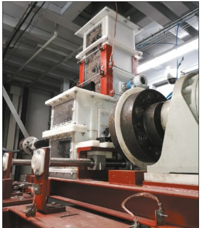
Рис. 24. Двухвалковое устройство для электроплазмоллиза стружки сахарной свёклы компании «Маген» производительностью 1 т/ч
