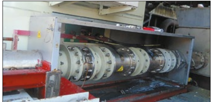
Рис. 23. Горизонтальная камера для электроплазмоллиза стружки сахарной свёклы компании «Маген» производительностью 10 т/ч
