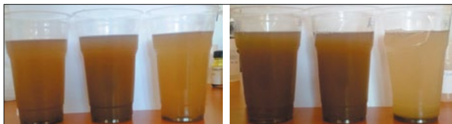
Рис. 1. Результаты осветления пробы ТМВ от 26.09.2017 слева направо: Amerfloc® 491, Praestol® 187TR, Amerfloc® 412, продукт-конкурент, Praestol® A3040L, Praestol® 185TR
