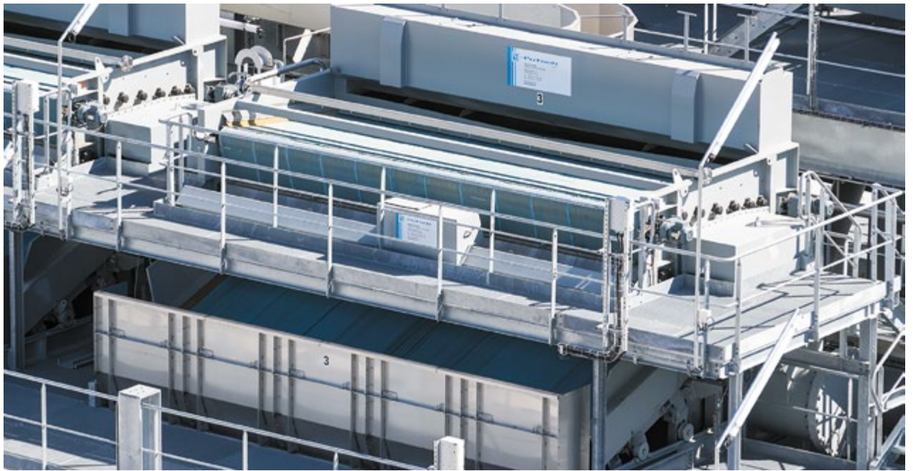
Putsch® - Фильтр транспортерно-моечных вод Putsch® - Разделительный транспортер для классификации органики и возврата товарной свекломассы в производство
