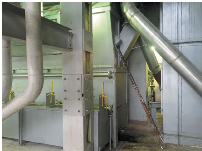
Рис. 6. Аппарат охлаждения сахара-песка с кипящим (псевдоожигненным) слоем модели ОКСТП-40С
