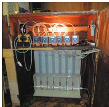
Рис. 6. Установка для автоматического приготовления рабочего раствора антинакипина
