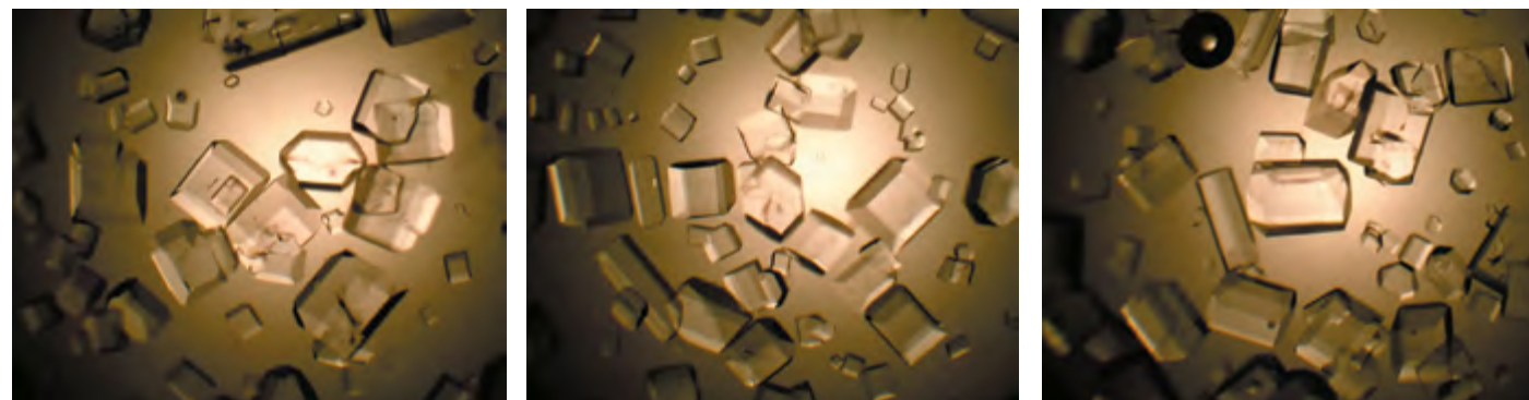
Рис. 2. Кристаллоструктура утфеля первого продукта, микросъёмка с увеличением 10 x
