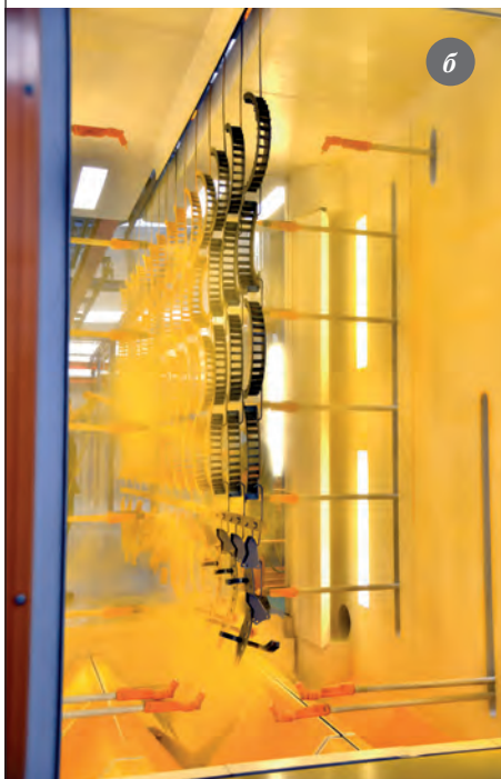
Новые камеры дробеструйной обработки деталей (а) и порошковой покраски (б, в)
