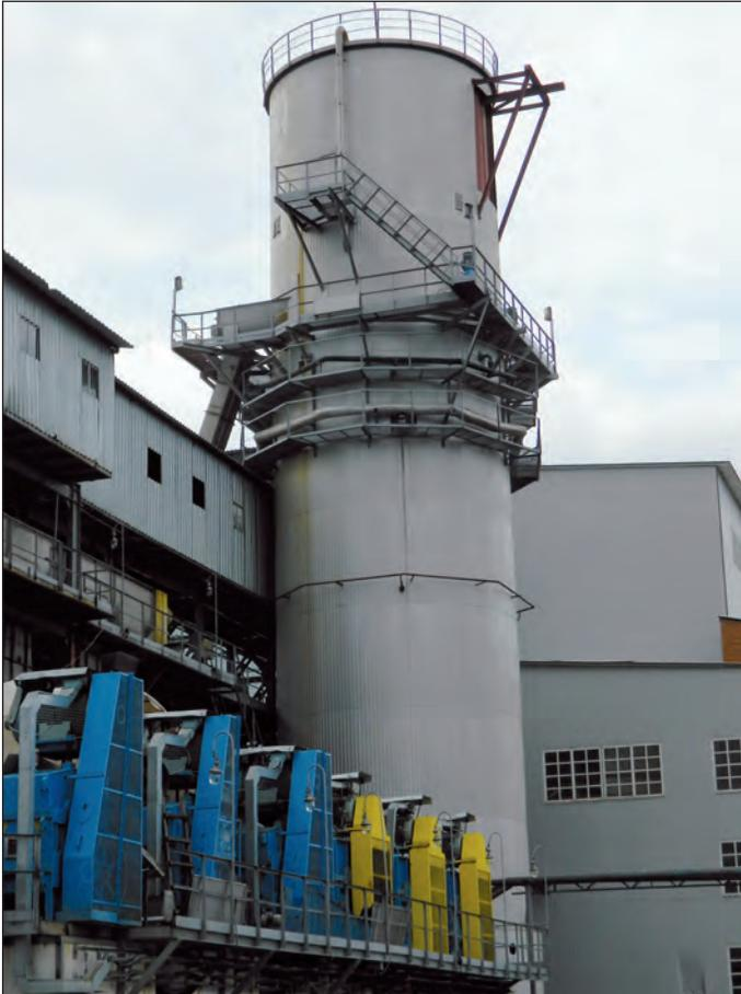
*Колонный диффузионный аппарат фирмы ВМА (Германия)*
