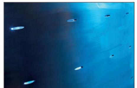
*Рис. 2. Эллиптические выпускные отверстия в рубашке ротора*
