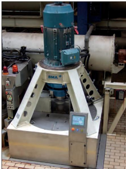
Рис. 3. Опытный образец центрифуги E1810
