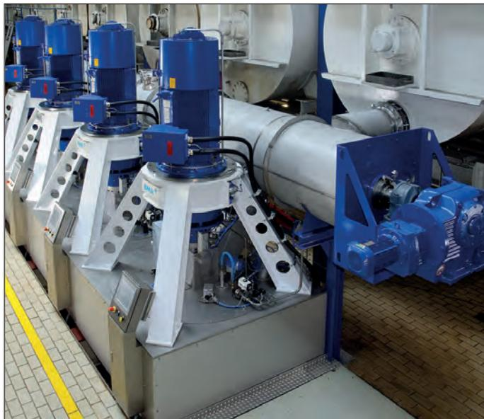
Рис. 4. Станция центрифуг (в г. Платтлинг) с 4 центрифугами E1810 и утфелераспределителем ВМА
