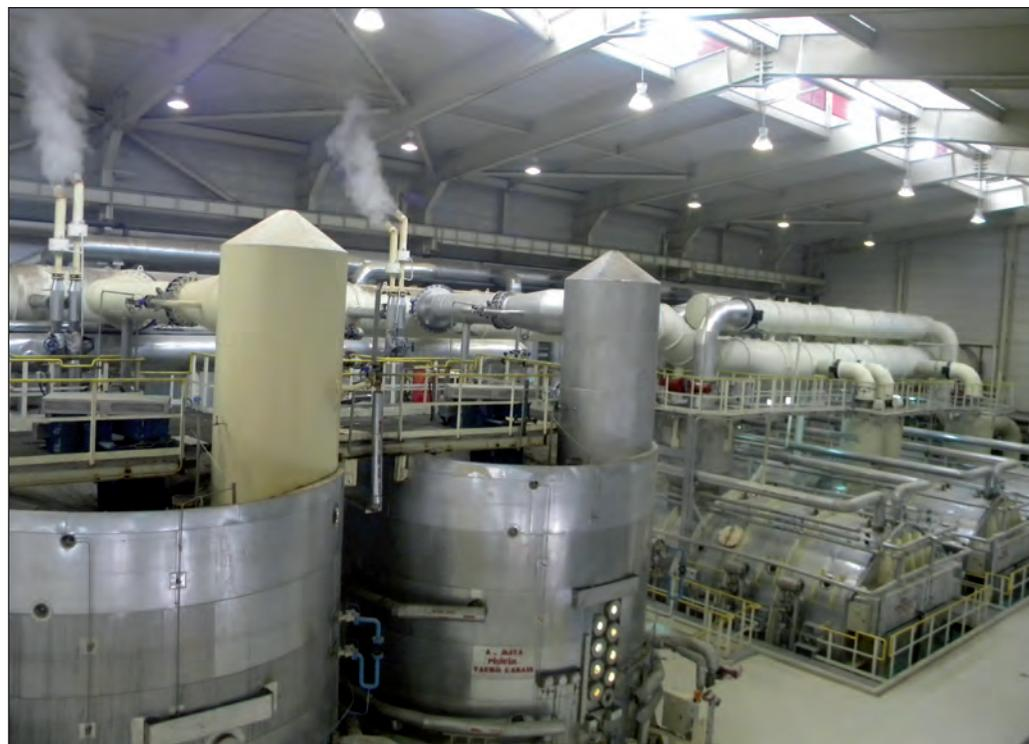
**Рис. 3. Периодические вакуум-аппараты маточного утфеля (слева) и горизонтальные CVP I, II, III кристаллизации на сахарном заводе Богазлян (Турция)**
