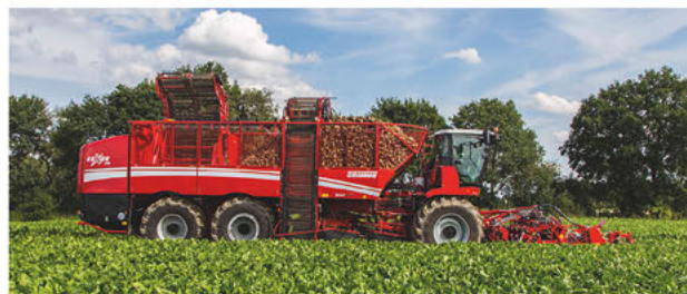
REXOR 630: 3-х осный 6-ти рядный комбайн с 30-ти тонным бункером. Дисковые копачи для работы в самых тяжелых условиях. Двигатель Mercedes-Benz 625 л.с
