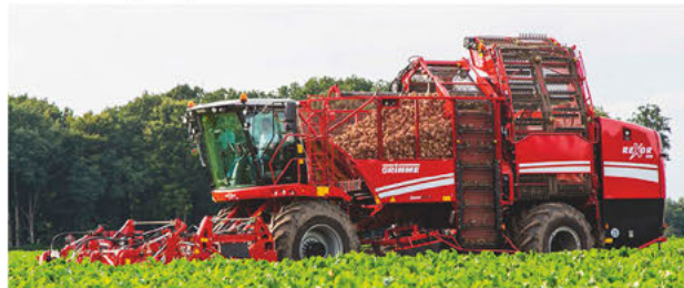
REXOR 620: 2-х осный, 6-ти рядный комбайн с 22-ти тонным бункером. Дисковые копачи для работы в самых тяжелых условиях. Двигатель Mercedes-Benz 625 л.с
