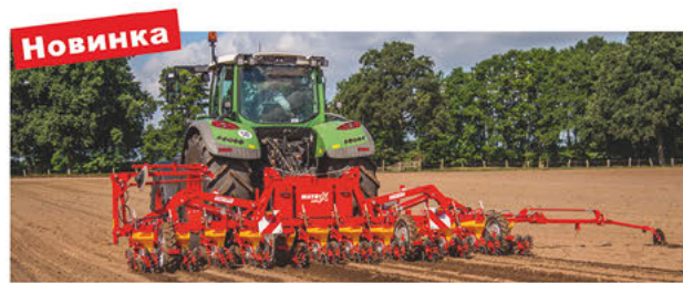
MATRIX 1200/1800: механическая сеялка пунктирного высева предлагается в 12- и 18-рядном исполнении с шириной междурядья 45, 48 или 50 см
