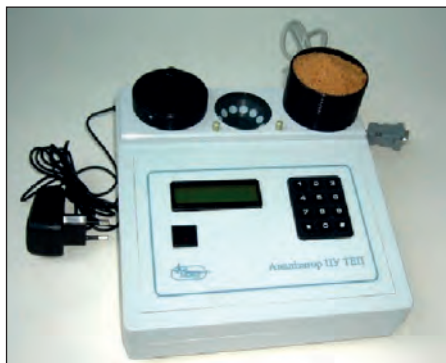
Рис. 2. Общий вид анализатора ЦУ ТЕП-СМ1 для автоматического контроля цветности кристаллического жёлтого сахара без разбавления
