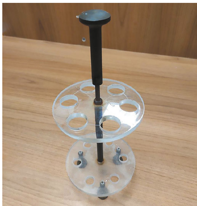
Рис. 4. Устройство, предназначенное для установки пробирок
