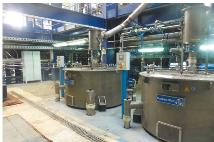
Рис. 2. Центрифуги непрерывного действия Viscaku-Wolf
