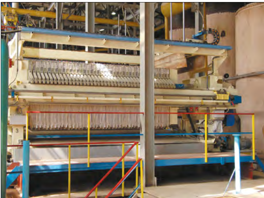
Рис. 1. Фильтр-пресс с полипропиленовыми плитами для фильтрования густых сиропов СВ=70–72%
