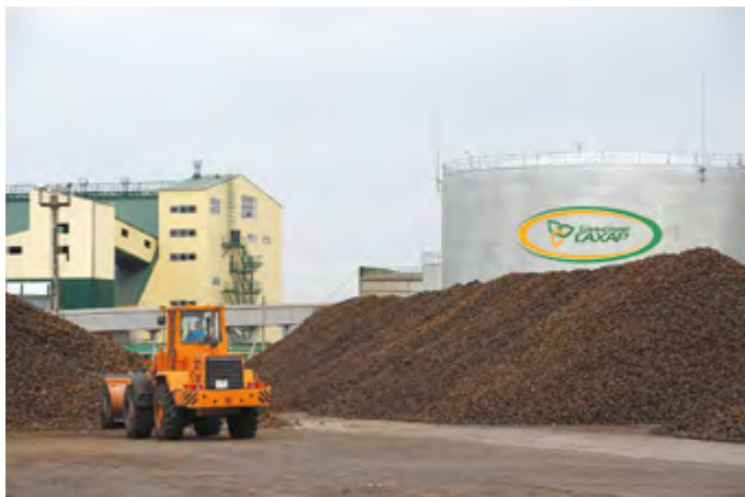
Хранение и подача сахарной свёклы в завод. На заднем плане: слева — склад гранулированного жома на 27 тыс. т; справа — резервуар для хранения мелассы на 10 тыс. м 2
