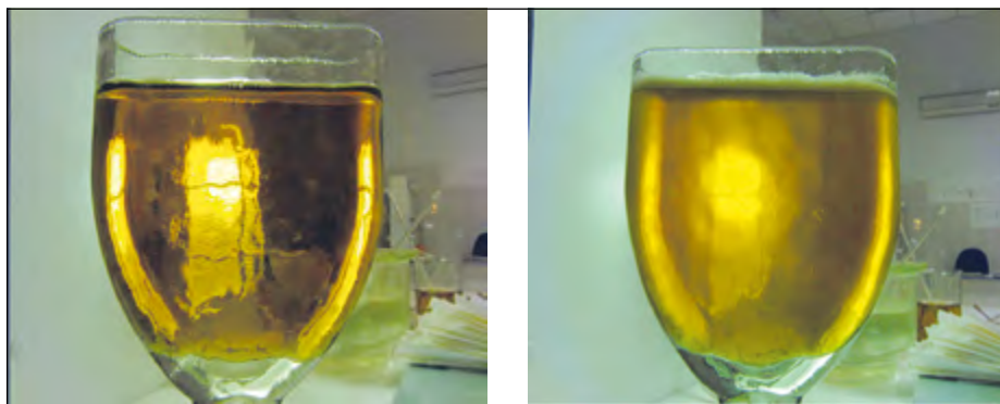
Рис. 3. Пробы густого сиропа: слева – после фильтрации на фильтр-прессе с использованием фильтроперлита, справа – нефильтрованная
