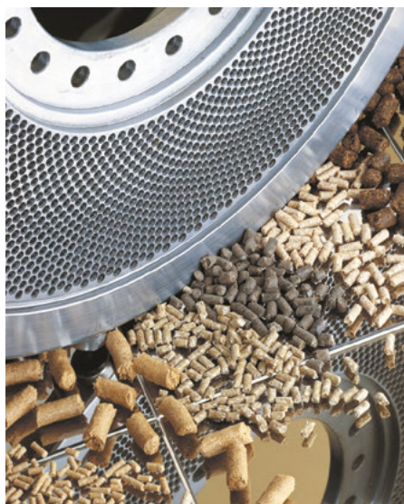
Рис. 3. Плоская матрица и различные гранулированные продукты
