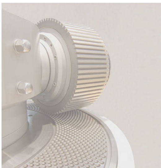
Рис. 1. Роликовая головка и плоская матрица
