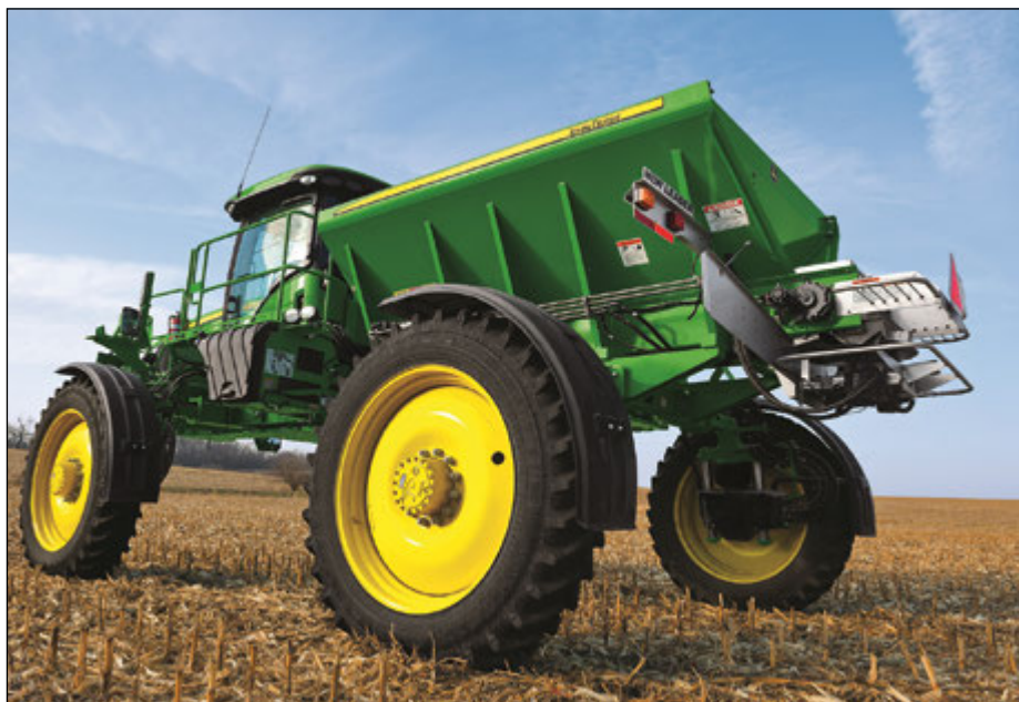
Рис. 2. Самоходный опрыскиватель John Deere 4045 с приспособлением для внесения удобрений Dry Box
