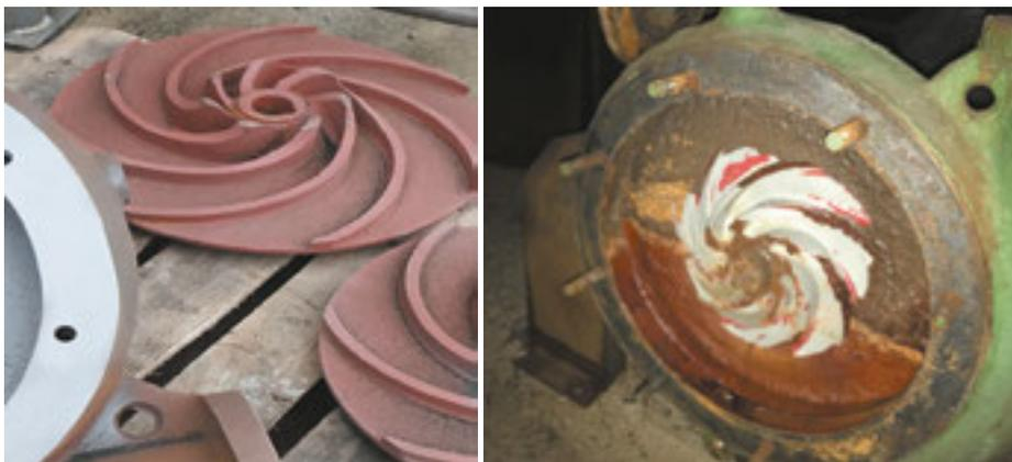
Рис. 2. Рабочее колесо насоса СОР-60: а) до эксплуатации; б) после 20 дней эксплуатации (окрашен кустарным способом рабочими завода)
